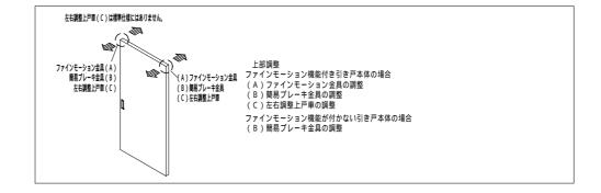
建て付けの調整は手動式プラスドライバーを用いて行います。
