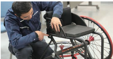
「このボルト締めが適度なしなりを生みます」
