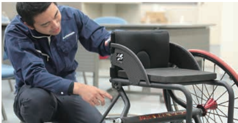
「力を多く生み出す箇所は、パイプを太くして対応しています」と岡川さん
